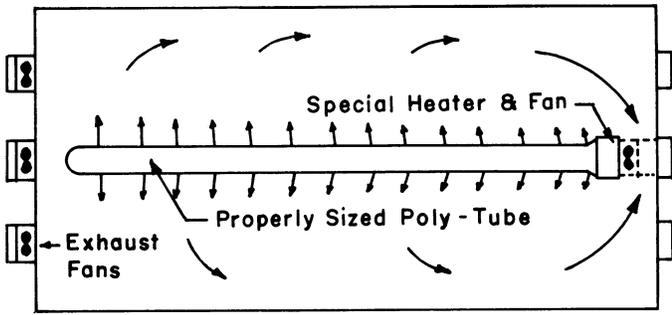
a. Combination heater and poly-tube fan unit
